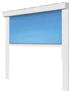
Tenda a caduta con rullo avvolgitore di Ø 70 mm in lamiera zincata, con guide laterali in alluminio (sezione 110 × 30 mm). Terminale in alluminio (sezione 22 × 60 mm) e supporti in fusione di alluminio.
