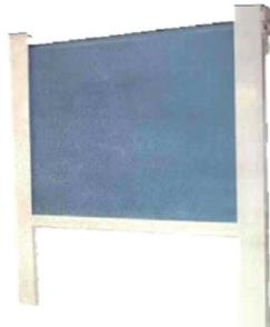
Tenda a caduta con rullo avvolgitore di Ø 70 mm in lamiera zincata, con guide laterali in alluminio (sezione 110 × 30 mm). Terminale in alluminio (sezione 22 × 60 mm) e supporti in fusione di alluminio.
